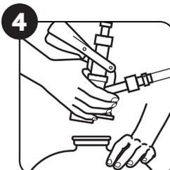
4 Retire el cabezal de llenado del accesorio del barril
