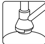
Coloque y centre el cabezal de llenado. Si el cabezal de llenado se coloca con dificultad, ¡está defectuoso!
